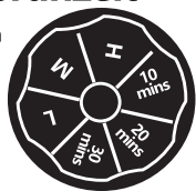
Empfindlichkeitsschalter Sprühzeit anpassen
