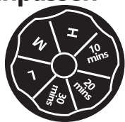
Gevoeligheidsknop Sproeitijd aanpassen
